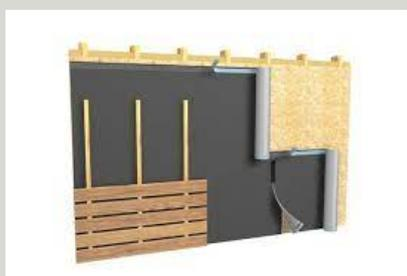
**Membrana com superfície da cor preta, adapta-se a uma grande variedade de materiais e técnicas de fixação, para revestimento de fachadas ventiladas, abertas ou transparentes, como madeira, aço expandido, vidro, etc.**
